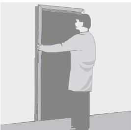
4. Zarge in der Maueröffnung lotrecht ausrichten, verkeilen und im Bereich der Bänder und des Schließblechs ausspreizen.\*
