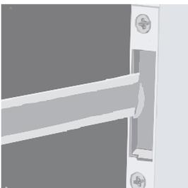
8. Bei Bedarf kann die Kunststoffnase in der Schlossfallenaussparung mittels eines Stecheisens nachgestochen werden.
