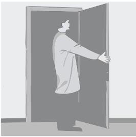
5. Bandunterteile in die Bandtasche einsetzen, Türblatt einhängen, Gangbarkeit und Schließfunktion prüfen.
