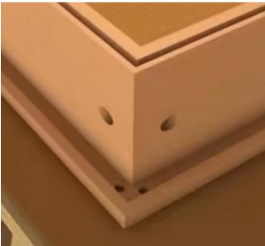
Fügen Sie anschließend die Zargenteile zusammen. Achten Sie darauf, dass die Gehrungen flächenbündig sind.
