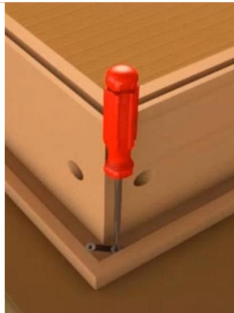
Setzen Sie die Exzenter in die Bohrung ein. Ziehen Sie diese dann erst leicht an.
