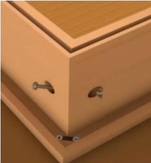
Kontrollieren Sie noch einmal die Gehrungsflächen, danach können Sie die Exzenter fest anziehen. Verschrauben Sie die Zargenteile mit den Schrauben und den Krallenmuttern.
