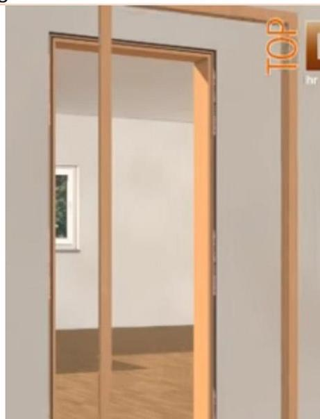
Schäumen Sie anschließend im Bereich der Türspreizer den Spalt zwischen Zarge und Mauerwerk aus. Entfernen Sie die Türspreiten und Keile nach dem Aushärten des Schaumes.
