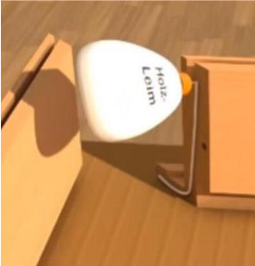
Entfernen Sie zunächst die Bandunterteile und tragen Sie anschließend auf die Gehrugsschnittfläche Holzleim auf.
